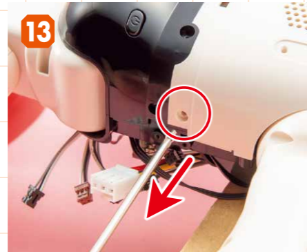
13 頭部が右側になるようにATOMの向きを変え、胴体カバー(後)の右側にある2×4mmビスを外します。
