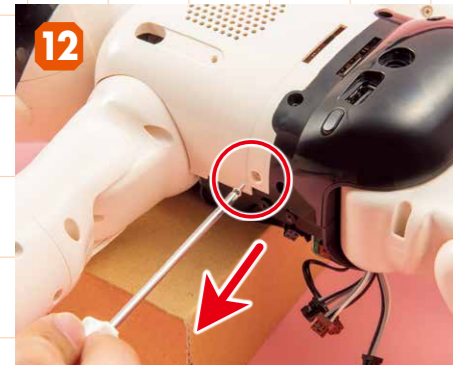
12 頭部が左側になるよう向きを変えてからATOMをうつ伏せにし、胴体カバー(後)の左側にある2×4mmビスを外します。
