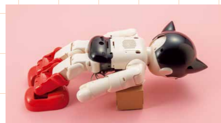
11 頭部と両腕から伸びるサーボモーター用ハーネス(4本)と中継ハーネス(2本)を引き抜いた状態を確認しましょう。フレキケーブルは引き抜かないでください。
