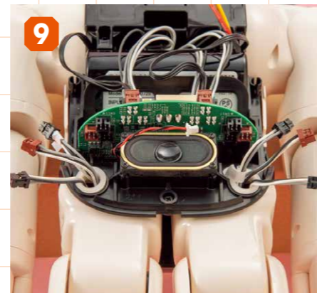
9 メインボード下面(脚側)から伸びてるスピーカーハーネスとサーボモーター用ハーネス、中継ハーネスを引き抜いた状態を確認しましょう。
