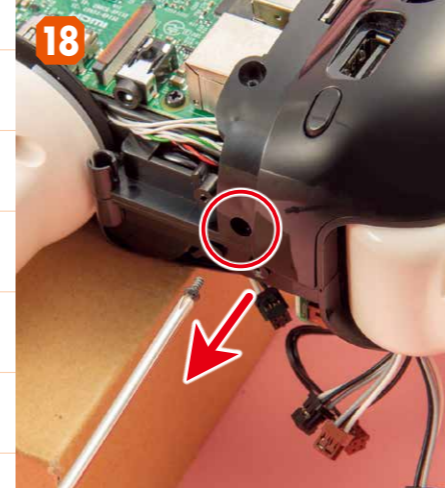
18 頭部が左側になるようにATOMの向きを変え、パンツ(後)の左側にあるビス穴から、2×4mmビス(黒)を外します。
