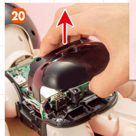
20 パンツ(後)を取り外します。このとき、右側のボタンR(電源用)と左側のボタンL(WPS用)も外れるので、紛失しないように注意してください。
