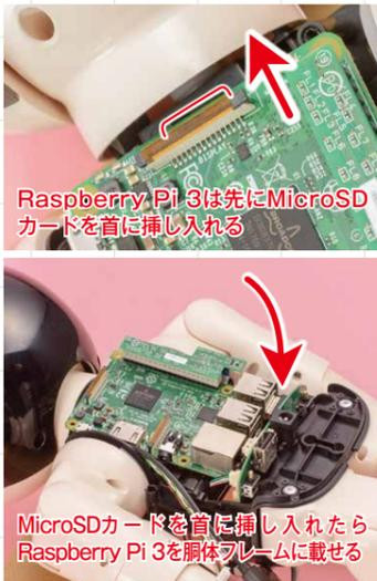
**24** ATOMの腰にメインボードを挿し込み背中にRaspberry Pi 3を載せる
