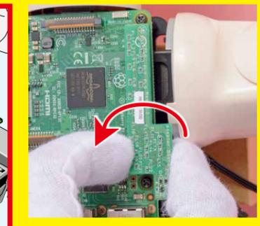
アダプターボードのジャック側が低くなっている場合は右肩のストッパーと接触する可能性があります。上記を参照して、ジャック側の位置を上げてください。
