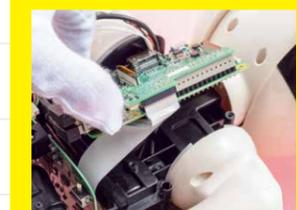
工程36で留めた4カ所の2.6×6mmビス(黒)を外し、フレキケーブルが伸び切らないように注意しながらRaspberry Pi 3を持ち上げます。
