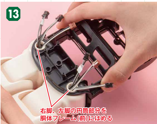
13 胴体フレーム(前)を取り付ける 両脚のハーネスを胴体フレーム(前)に通したら、胴体フレーム(後)に取り付けます。右脚、左脚の円筒部分がしっかりとハマっていることを確認しましょう。
