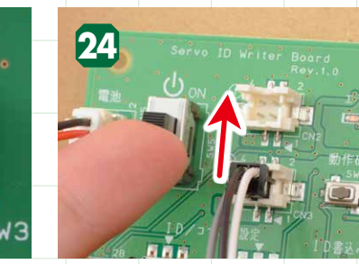
24 電源スイッチをONにする 簡易テスト基板の電源スイッチをONにします。
