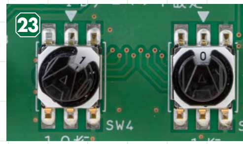
23 10桁を「1」、1桁を「0」に合わせる ロータリースイッチにスイッチ用ノブを取り付け、10桁の数字を「1」、1桁を「0」に合わせます。スイッチは1つの数字ごとにカチッと手応えがある仕様になっているので、手応えを感じながら回すと正しく合わせられます。
