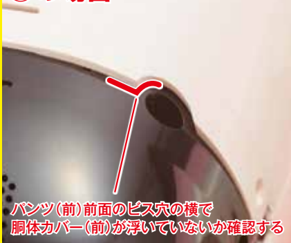
すべてのハーネスを胴体フレームの内側に収め、バッテリーの上でケーブルやサーボモーター用ハーネスを重ねない。
