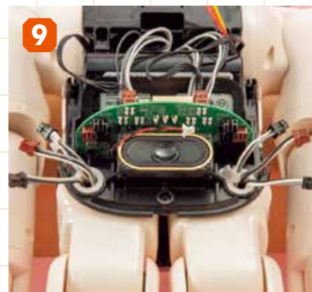
9 メインボード下面(脚側)から伸びてるスピーカーハーネスとサーボモーター用ハーネス、中継ハーネスを引き抜いた状態を確認しましょう。
