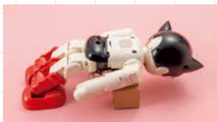
11 頭部と両腕から伸びるサーボモーター用ハーネス(4本)と中継ハーネス(2本)を引き抜いた状態を確認しましょう。フレキケーブルは引き抜かないでください。
