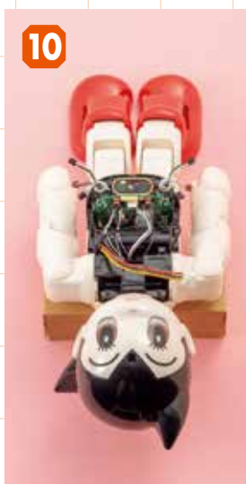
10 頭部が手前(下)になるようにATOMの向きを変え、メインボード上面(頭部側)に挿し込まれているサーボモーター用ハーネスと中継ハーネスを引き抜きます。
