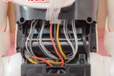
すべてのハーネスを胴体フレームの内側に収め、バッテリーの上でケーブルやサーボモーター用ハーネスを重ねない。
