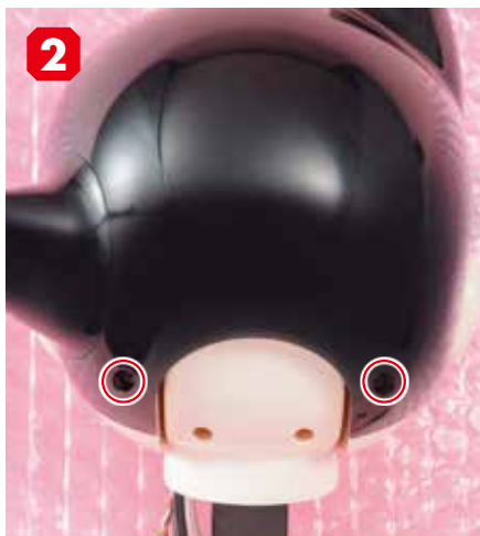
後頭部にある2つのビス穴を確認する。
