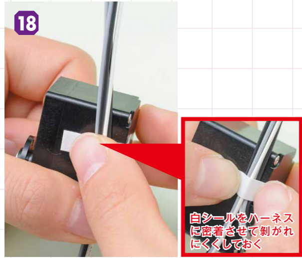
18 中継ハーネスを仮留めする 工程⑭で貼った2枚目の白シールを使って中継ハーネスを仮留めします。ここでも白シールをしっかりと密着させ、作業中に剥がれないようにしましょう。
