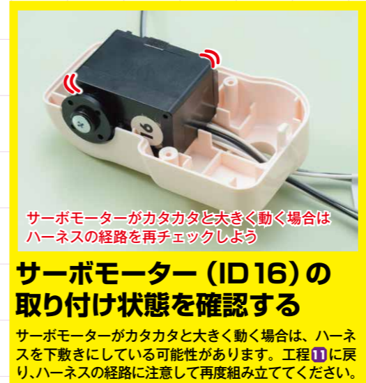
24 サーボモーター (ID16) の取り付け状態を確認する サーボモーターがカタカタと大きく動く場合は、ハーネスを下向きにしている可能性があります。工程⑮に戻り、ハーネスの経路に注意して再度組み立ててください。
