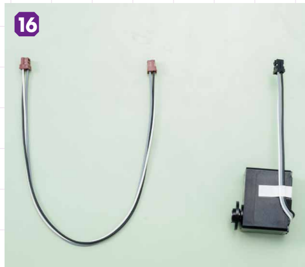
16 中継ハーネスを用意する 44号で提供した⑥中継ハーネス220mm (脚用) を用意します。
