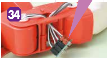
4連ハブ基板を取り付けた状態。
