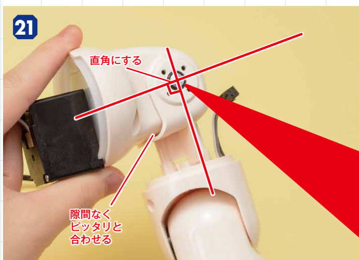
21 左上腕と左肩の角度を合わせる 左の写真のように、サーボモーター（ID8）のサーボホーンを軸に、左上腕と左肩の角度を直角にすると樹脂パーツの切り欠きと、サーボホーンの小さな突起が一致します。この状態にすると、樹脂パーツとサーボホーンが一致してビス留めを行うことができます。
