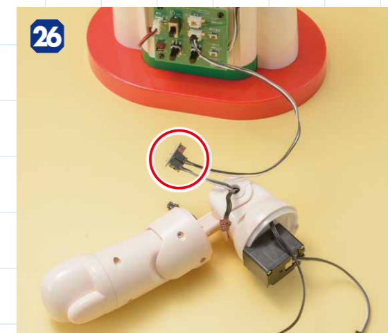
26 サーボモーター（ID8）のハーネスを3連ハブ基板に取り付けた状態 左肩から伸びたハーネスが、テスト基板用延長ハーネスを経由してチェックスタンドのテスト基板に正しく接続されているか確認しましょう。
