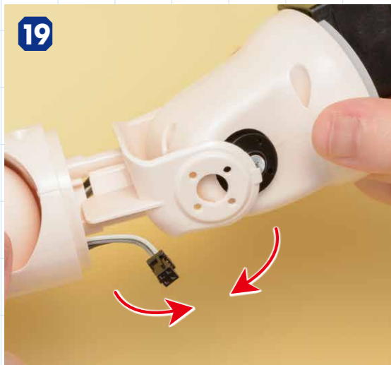
19 左上腕フレームに左肩のサーボホーンをはめ込む 工程18で引っ掛けた部分を軸に、左上腕フレームの反対側、ビス穴がある方の穴に左肩のサーボホーンをはめ込みます。
