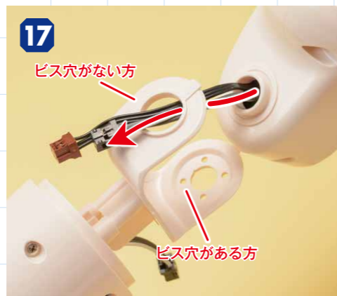
17 左上腕フレームにハーネスを通す 左上腕フレームのビス穴がない方の穴に、左肩から伸びる2本のハーネス（サーボモーターID8用と中継ハーネス）のコネクタを通します。2本を同時に通すことはできないので、1本ずつ通しましょう。
