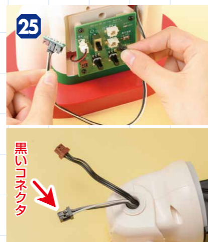
25 サーボモーター（ID8）のハーネスをテスト基板用延長ハーネスの3連ハブ基板に取り付ける チェックスタンドを用意し、テスト基板にテスト基板用延長ハーネスを取り付けます。その後、左肩から伸びているサーボモーター（ID8）のハーネスの黒いコネクタ（写真左下赤矢印）を、テスト基板用延長ハーネスの3連ハブ基板に取り付けます。
