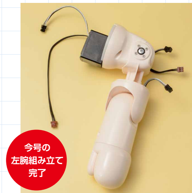
23 ビス留めをする ビス留めは対角線上にひとつずつ仮留めをしてから、最後に本締めを行いましょう。ビスは奥まで締めても回り続けますが、ビスの頭が写真のように隙間なく留まっていれば問題ありません。
