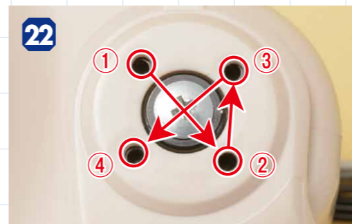
22 ビス穴を確認する サーボホーンと左上腕フレームのビス穴が一致したら④ 2×4mmビスを使い、4つあるビス穴をビス留めします。このとき、工程21のように左肩と左上腕を直角にしていないと、後の動作確認で異常となるので必ず確認しましょう。
