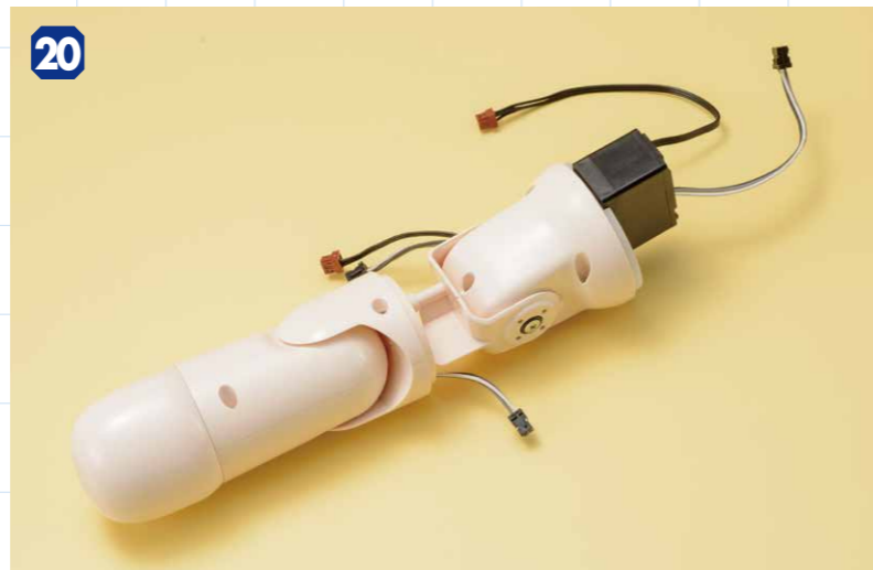
20 左上腕フレームに左肩を取り付けた状態 左上腕フレームに左肩がうまくはまれば、左肩のサーボホーンを軸にして左上腕をスムーズに動かすことができます。動きに抵抗を感じる場合はサーボホーンなどがうまく噛み合っていない可能性がありますので、17~19を確認してください。
