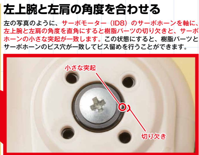
20 左上腕フレームに左肩を取り付けた状態 左上腕フレームに左肩がうまくはまれば、左肩のサーボホーンを軸にして左上腕をスムーズに動かすことができます。動きに抵抗を感じる場合はサーボホーンなどがうまく噛み合っていない可能性がありますので、17~19を確認してください。
