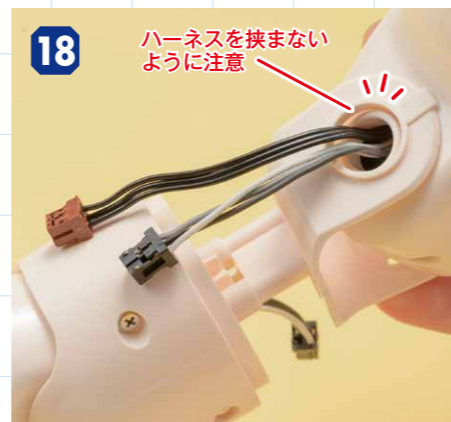
18 左上腕フレームに左肩のパイプを引っ掛ける ハーネスを伝って左上腕フレームのビス穴がない方の穴に左肩にあるパイプ部分を引っ掛けます。このとき、ハーネスを挟まないように注意してください。
